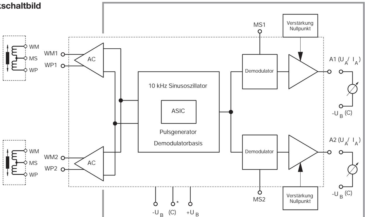
\* Bei SM125 an C Betriebsspannung 0V anlegen
